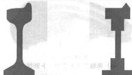
(a) 在来鉄道用 C 形平板車輪 (b) 簡略化車輪
