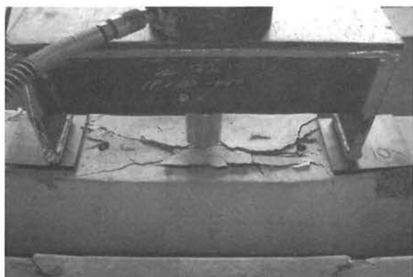
図 8 代表的な破壊形態 (3H: アンカー深さ 105 mm の例)
