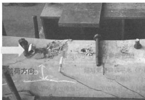
図 4 ボルト破断による破壊形態 (3H: アンカー深さ 90 mmの例)
