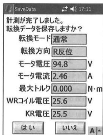
図5 転換完了後代表値表示画面 Fig. 5. Wait for throwing
