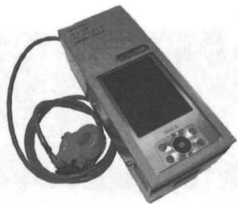
図1 転てつ機ハンディモニタ外観
