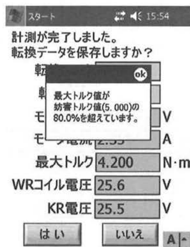
図7 トルク値警告画面 Fig. 7. Warning by over torque limit
