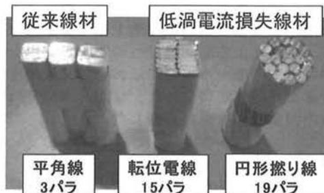
図 1 渦電流損失定量比較用素線サンプル
