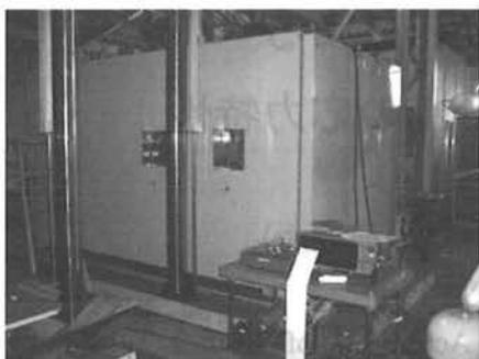
図 2 恒温室付疲労試験装置
