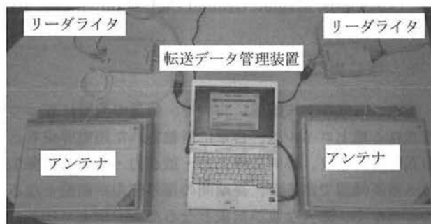
図 4 地上コイル保守運用管理支援装置 (車載品)
