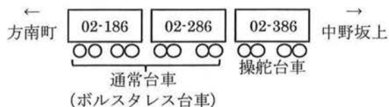
図14 操舵台車装着部位
