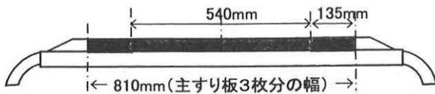
図4 主すり板3枚幅化
