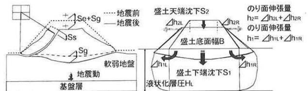
図.1 盛土の沈下成分(左:円弧 右:液状化)
