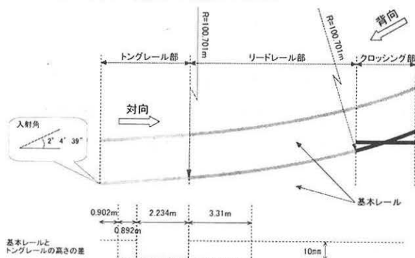
図2 側線用8番分岐器の略図
