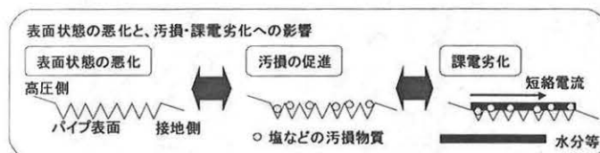
図2 FRPパイプ表面の劣化メカニズム
