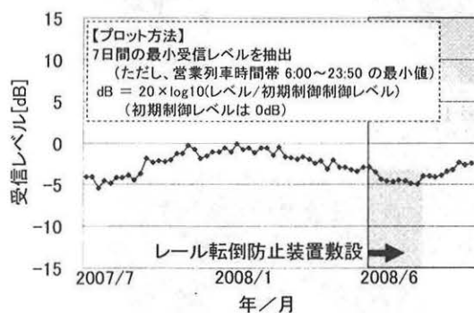
図 13 軌道回路の受信レベルの変動
