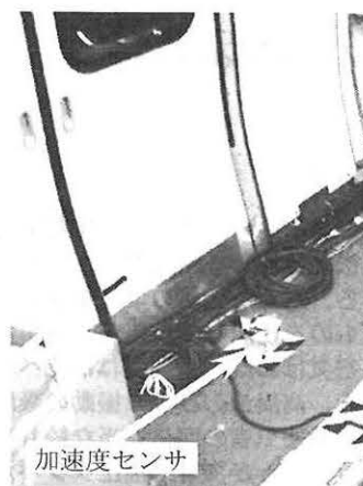
図7 車体床面に取り付けた加速度センサ
