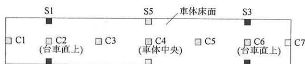
図6 車体床面の加速度センサの配置（平面図）
