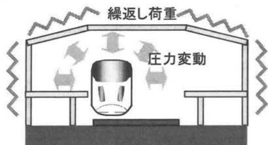
図2 圧力変動の弊害
