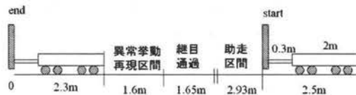
図5 脱線再現試験の走行コース
