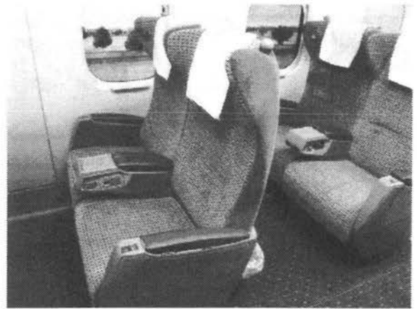
図 6 グリーン車腰掛とカーペットを設置した状態
