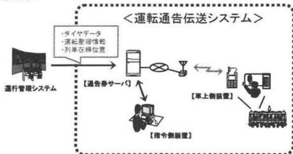
図1 運転通告伝送システムの構成
