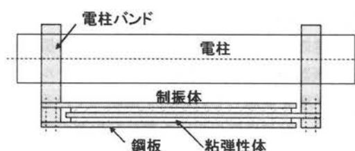
図2 電柱制振器の構造概要
