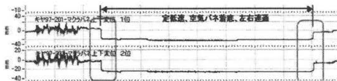
図 9 空気バネ着底機能確認
