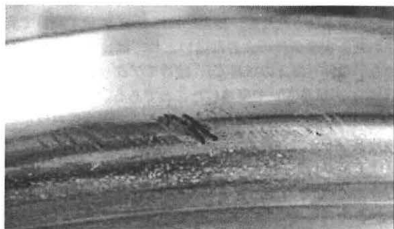
図 7 きしみ傷からののはく離
