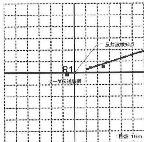
図6 保守用車の検知状態
