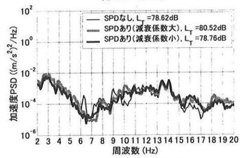
図 6 応答加速度 PSD (実走行模擬加振, 速度 100km/h 相当)
