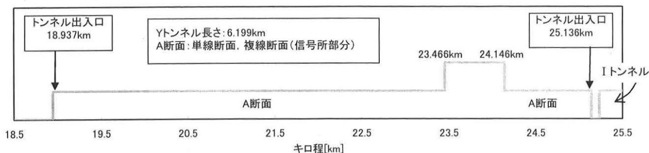
図2 Yトンネルの構造図
