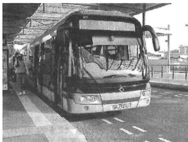
図 13. 光学ガイドタイヤトラム (CIVIS) 車両
