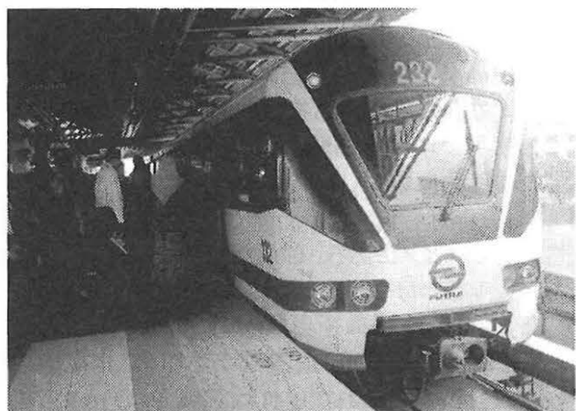
図9 最新のリニアモータ駆動、自動運転システムを導入したクアラルンプルのブトラ線[4]
