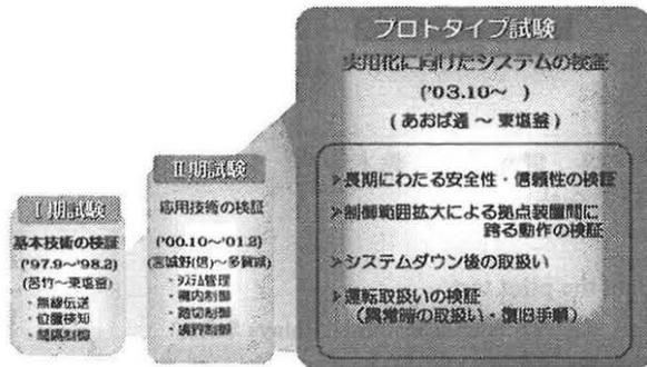
図 2 ATACS プロトタイプ試験の目的
