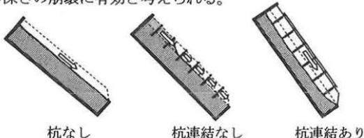
図 3 ラセン杭施工時の崩壊形態
