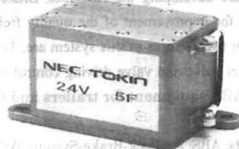
図3. 試作した車両用電気二重層キャパシタ Fig.3. Prototype EDLC for ABS on vehicles
