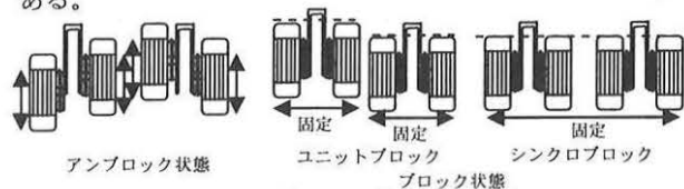
Fig.3 ブロック削正の概念図
