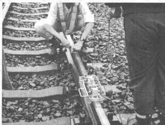
図5 レール動摩擦係数測定風景
