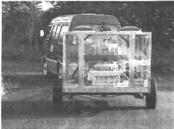
図7. 電気自動車による牽引走行試験
