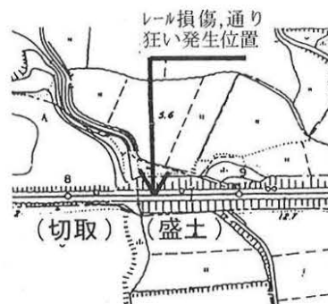
図9 レール通り狂い等の発生位置と地盤 8) (事例6)
