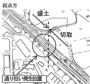
図 11 レール通り狂い位置と地盤 8) (事例 7)
