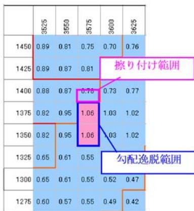
図-7 不同沈下シミュレーションによる勾配算定結果（3年後）における勾配逸脱範囲の一例
