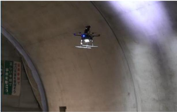
写真-5 自律飛行ドローンによる自動撮影状況
