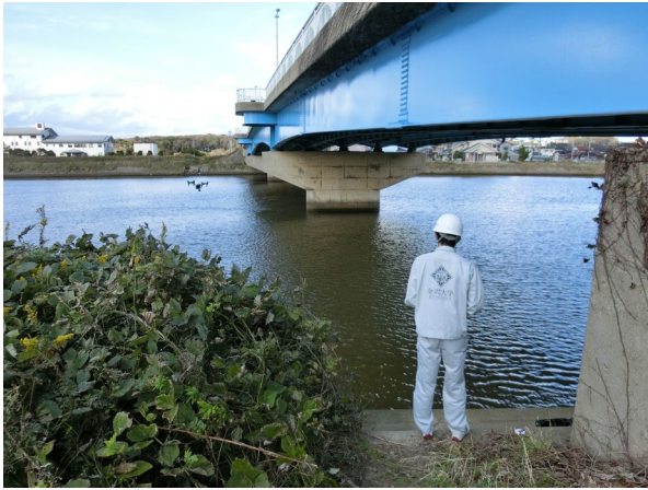
図-3 赤外線カメラ搭載 UAV での撮影様子
