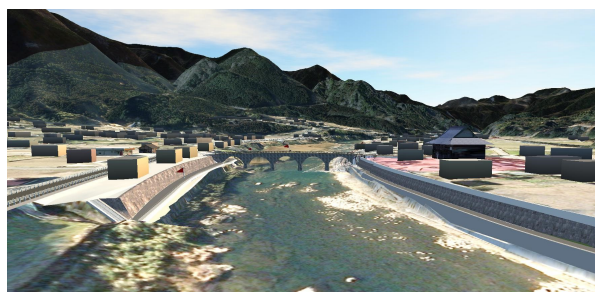
図-5 モデル空間上への堤防の配置
