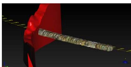
図-2 破砕帯地質モデル
