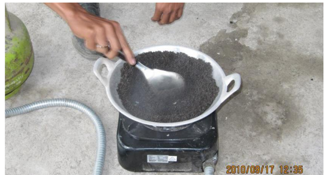
図-7 細骨材をフライパンで乾燥している様子
