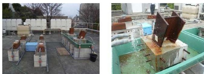
図-4 模擬劣化試験体の促進腐食実験
