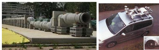
図-6 模擬劣化試験体と路上からのレーザ測量装置
