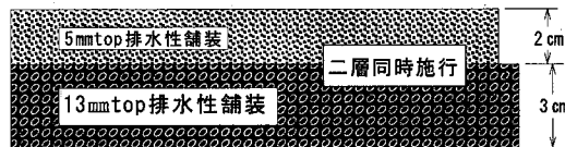
図－１ 二層式排水性舗装の模式図
