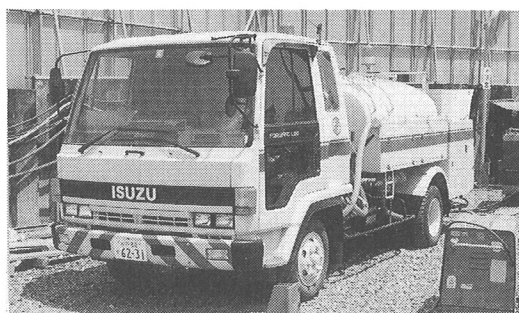
写真－３ 高圧洗浄車
