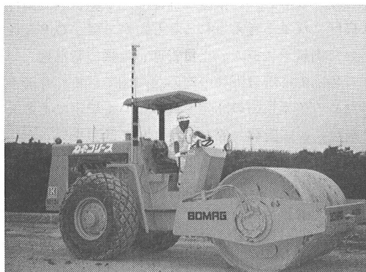
写真－3 ローラーに搭載したアンテナ
