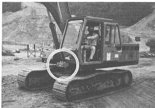
写真-1 重機転倒防止警告装置(1)
