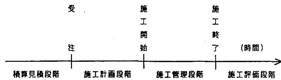
図-1 建設工事の各段階
