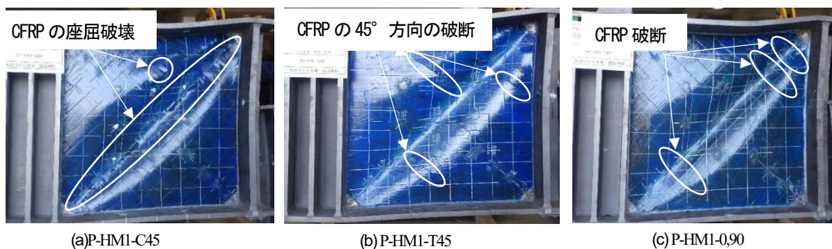
図-14 破壊状況（繊維方向の比較）
