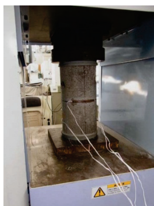
図-15 圧縮試験の実施状況（無補強供試体）
