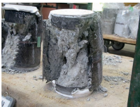
図-17 圧縮試験による供試体の破壊状況（供試体 B）
