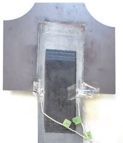
図-6 CFRP 接着の状況
