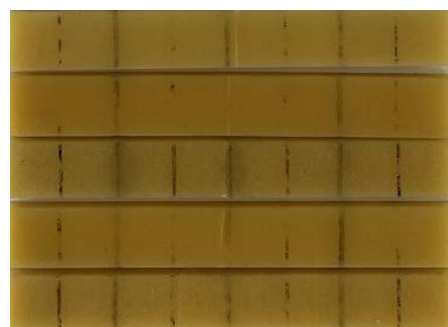
写真-5 蒸留水 60℃ 52 週浸漬後試験体
