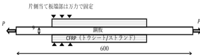
試験法B：ダブルストラップ接合部の引張試験
