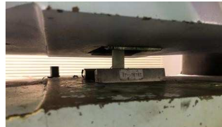
図-4 45°方向引張試験のセットアップ
