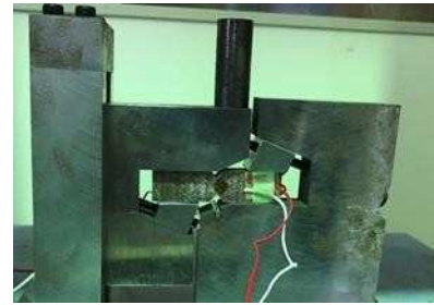
図-12 Vノッチビーム法試験のセットアップ
